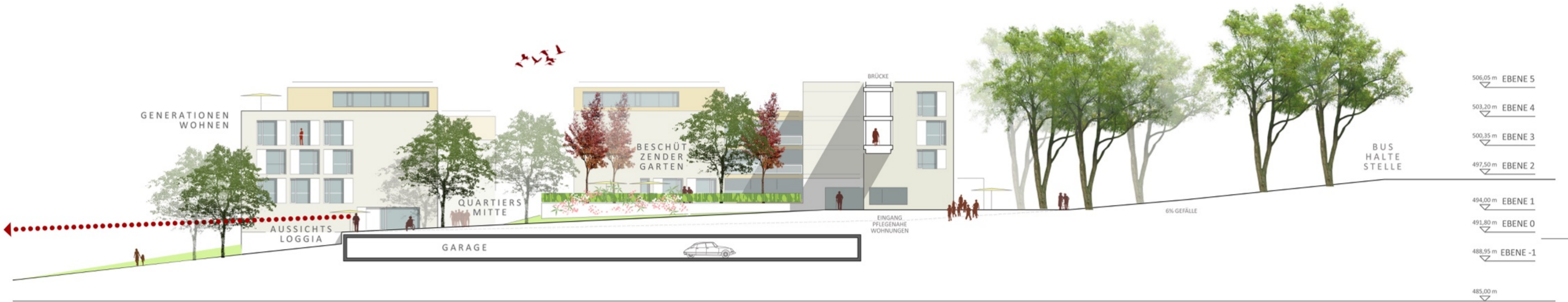
Schnitt OST-WEST 1:200 Durch das stetige Gefälle der vorhandenen Topografie wird eine räumliche Barriere zwischen dem beschützenden Garten und den halböffentlichen Außenbereichen geschaffen.
