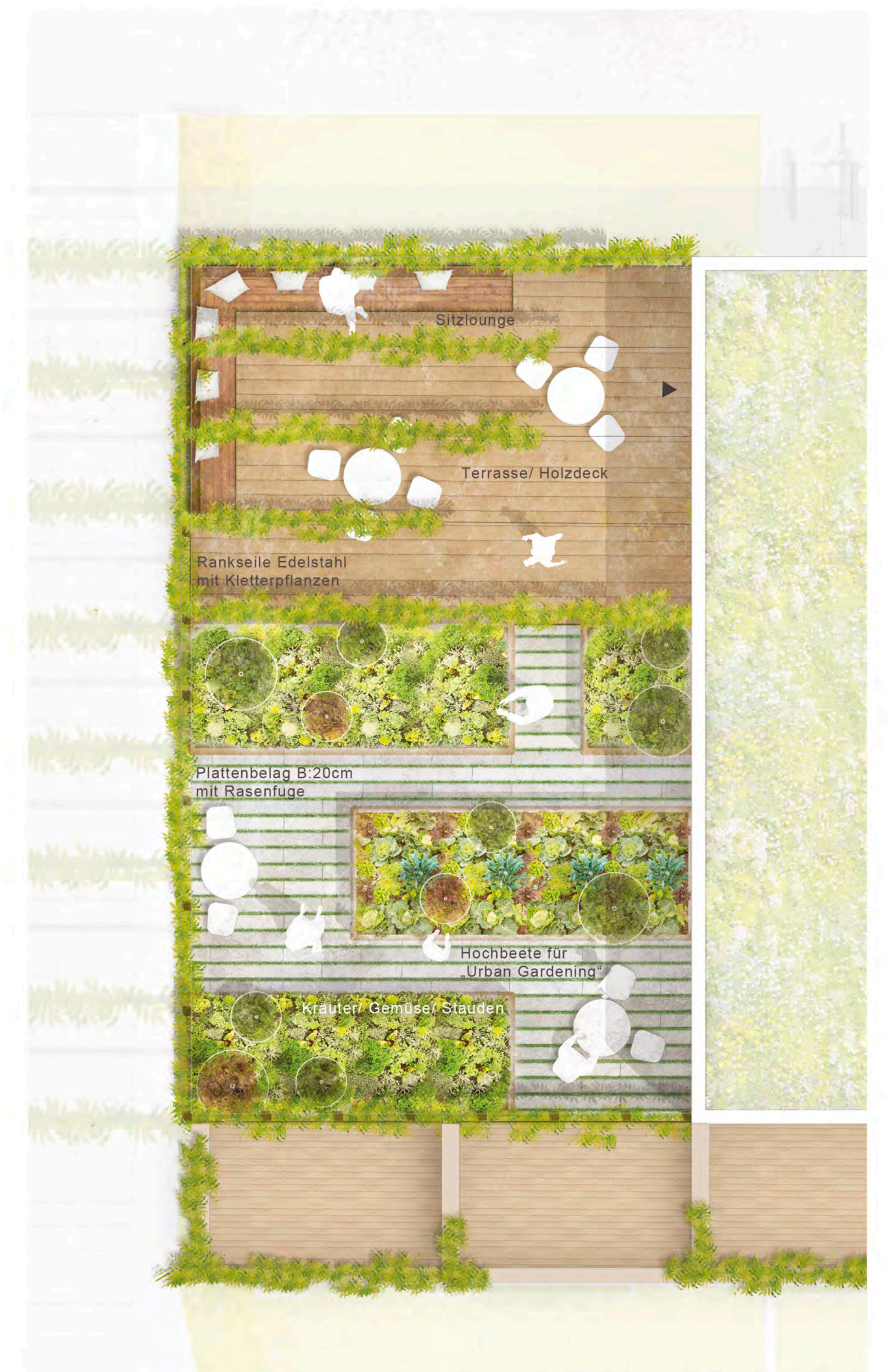
Detailplan Dachgarten Mehrfamilienhaus M 1:50
